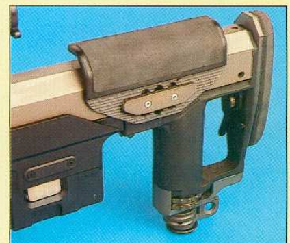
In questa immagine, si nota la sciina tipo Picatinny, di fatto una sciina Weaver, che permette il montaggio di accessori come il visore notturno o le lampade alogene. A destra: la porzione posteriore del calcio è praticamente senza limiti di regolazione. Anche l'appoggiaguancia è regolabile in elevazione.
