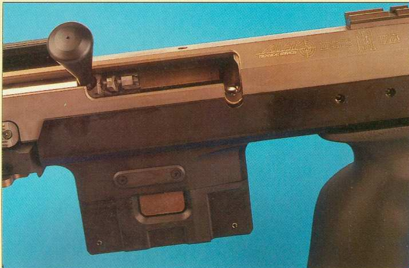
La finestra di espulsione garantisce la perfetta fuoriuscita dei bossoli spenti del .308 Winchester, calibro utilizzato nella nostra prova, ma si rivela idonea anche per calibri di dimensioni superiori.
